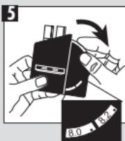
Guarde el comparador diagonalmente de modo que bastante luz diurna entre en la cubeta. La unidad del espejo hace uso la visión por la longitud entera de la cubeta. ⑩ Una vez realizada la igualación del color producido en la cubeta con el CHECKIT®Disc, leer el resultado en mg/l de cloro total.
