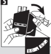
Mantenga il comparatore diagonalmente in modo che abbastanza luce del giorno entra nella cuvetta. L'unità dello specchio usa la vista dall'intera lunghezza della cuvetta.
