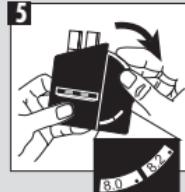
9 Nach 2 Minuten Reaktionszeit durch Abgleich mit der CHECKIT®Disc 10 das Ergebnis als Gesamtchlor in mg/l ablesen. Dabei Comparator schräg halten, damit genügend Tagesnordlicht von oben in die Küvette fällt. Die Spiegeleinheit nutzt die Durchsicht durch die gesamte Küvettenlänge.
