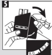
Tenir le comparateur penché de façon à laisser pénétrer suffisamment de lumière du jour dans la cuvette. Le miroir utilise la transparence de la cuvette sur toute sa longueur. Faire concorder la couleur obtenue avec le CHECKIT® Disc et ⑩ lire le résultat en mg/l de chlore total.
