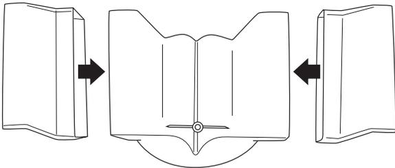
2. Adhiera el soporte de montaje de conductos con recirculación al conducto mismo, utilizando el tornillo para cubiertas de conductos suministrado con el paquete de herramientas.
