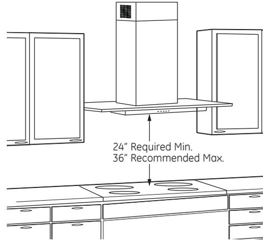
La campana de ventilación debe ser instalada entre el mínimo requerido de 24" y el máximo recomendado de 36" sobre la superficie de cocción. La altura de instalación de la campana sobre la superficie de cocción depende de la altura del cielorraso y las limitaciones de la cubierta del conducto. La cubierta plegable oculta los conductos que van desde la parte superior de la campana hasta el cielorraso. Para las alturas de cielorraso de las cubiertas de conductos, consulte la tabla de la página 5.
