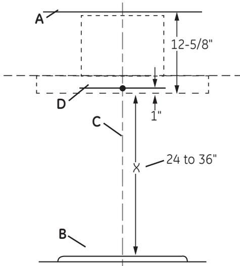
3. Alinee el extremo superior del soporte de montaje con la línea horizontal (A). Alinee las ranuras centrales del soporte con la línea central (C) y marque el centro de los agujeros del soporte. Retire el soporte para perforar los 2 sostenes de montaje de la base en la pared, donde se encuentran las marcas. Vuelva a colocar el soporte de montaje en la pared e instale los 2 tornillos de montaje con 2 arandelas en los sostenes. Ajuste los tornillos.
