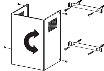
3. Instale la cubierta del conducto inferior. Lentamente separe los costados de la cubierta y enganche ambos detrás de la cubierta del conducto superior y de la pared. Deslice la cubierta del conducto superior hacia abajo para hacer que la misma coincida de forma segura con la parte superior de la campana extractora.
