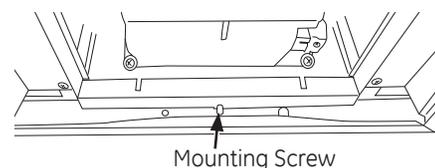
3. Asegure la campana al soporte de montaje, ajustando el tornillo de la cubierta del conducto en el agujero (B) a ambos lados del soporte mostrado previamente.
