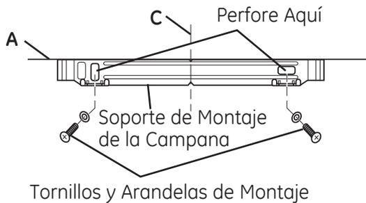
4. Dibuje una segunda línea horizontal (D) con 1" agregada desde la distancia X. Dibuje un agujero en la pared con una broca de 9/32" en la intersección de la línea horizontal (D) y la línea central vertical (C). Inserte un sostén en la cubierta del conducto.
