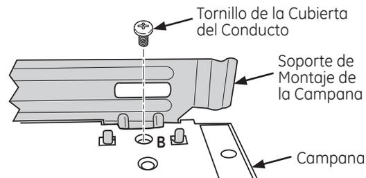
2. Coloque un tornillo de montaje en el sostén de la cubierta del conducto, sobre la ranura central provista en la parte inferior del lado trasero de la campana. Ajuste de forma segura.
