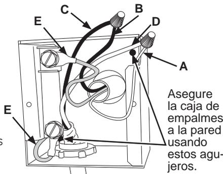
3. Asegure la caja de empalmes a la pared usando 2 tornillos autorroscantes para pared seca en los dos agujeros diagonales de la caja de empalmes. Vuelva a adherir la cubierta del compartimiento de cableado de campo.
