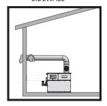
POWERED SIDEWALL W/DUCTED INTAKE
