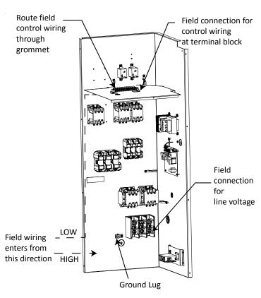
25 TONS MODEL POWER AND LOW VOLTAGE BLOCK LOCATIONS
