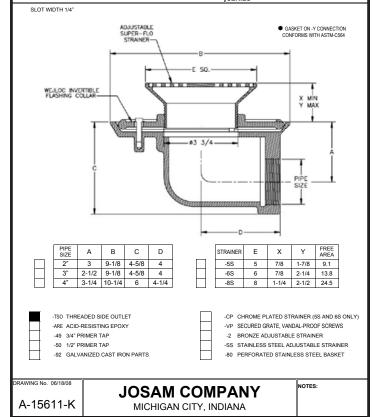
JOSAM SERIES 30304-Z-A COATED CAST IRON FLOOR DRAIN WITH JOSAM ADJUSTABLE ROUND NIKALOY STRAINER.
