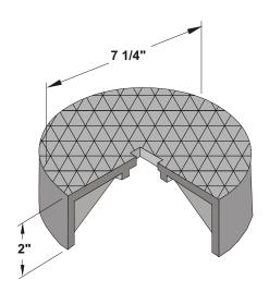
$\frac{\text{No. 1-RD-TG CAST IRON GRATE}}{\text{WT. 5 lbs.}}$
