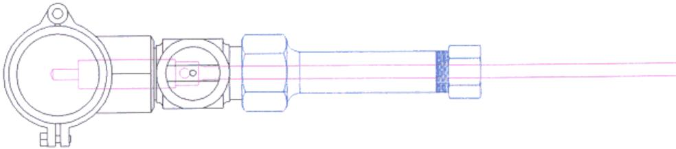
SLOWLY DRILL THROUGH ONE WALL OF THE MAIN. SLUG IS TRAPPED BETWEEN SAW.
