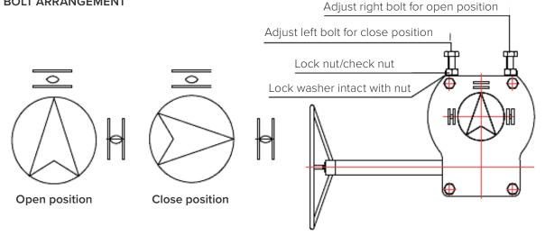
Fig. 6 Gear unit
