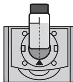
7. Retire el tubo del colorímetro. Añada una DPD #1 IG Tablet [6903A]. Tape el tubo y agite durante 10 segundos. Dele la vuelta lentamente 5 veces. La solución se volverá de color rosa si hay cloro libre.
