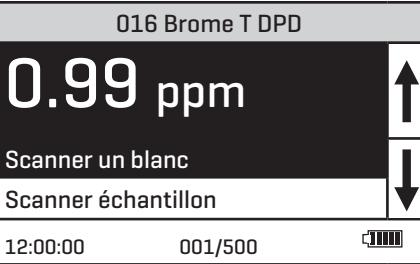
**REMARQUE :** Pour obtenir des résultats plus précis, diluez les échantillons dont la teneur en brome est supérieure à 7 ppm avec de l'eau sans chlore et effectuez à nouveau l'analyse.
