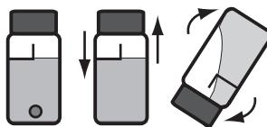
8. Inserte inmediatamente el tubo en la cámara. Cierre la tapa. Seleccione Escanear muestra. Registre el resultado como Cloro libre.
