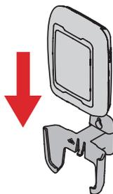
Installer la sonde dans son support, avec son dos faisant face au mur.
