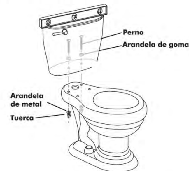
Junta hermética entre la cisterna y la taza
