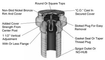
Fig. 12 The Twis-To-Floor<sup>®</sup> Cleanout
