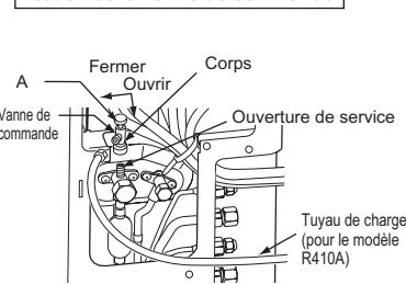
Lorsque vous fixez la vanne de commande à l'ouverture de service, le noyau de vanne peut se déformer ou se relâcher en cas de pression excessive. Cela peut entraîner une fuite de gaz.
