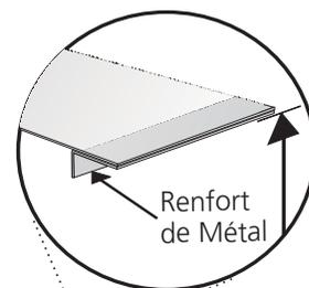
Afin d'installer correctement la cuisinière, la hauteur initiale entre le plancher et le renfort de métal en dessous de la table de cuisson doit être au moins 1/16" plus grande que les mesures du comptoir mesurés dans l'étape 1.
