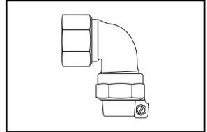
FEMALE COPPER THREAD SWIVEL NUT INLET BY PACK JOINT FOR COPPER OR PLASTIC TUBING (CTS) OUTLET
